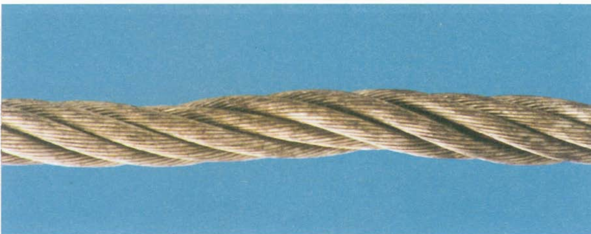
图 D.3 钢丝绳直径局部减小(绳股凹陷)
